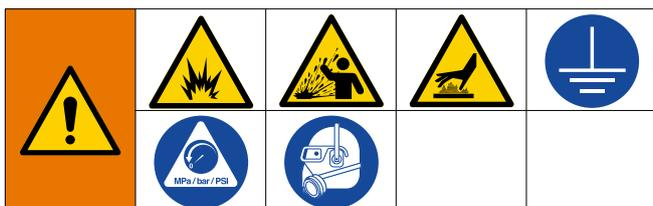
Во избежание пожара и взрыва всегда заземляйте оборудование и емкость для отходов. Во избежание электростатического искрения и получения травм из-за разбрызгивания всегда проводите промывку при наименьшем возможном давлении.
