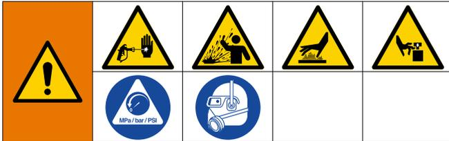
Это оборудование остается под давлением до тех пор, пока давление не будет сброшено вручную. Во избежание получения серьезной травмы, вызванной воздействием жидкости под давлением (например, в результате проникновения под кожу, разбрызгивания жидкости и контакта с движущимися деталями), выполняйте процедуру сброса давления после каждого завершения распыления и перед очисткой, проверкой либо обслуживанием оборудования.
